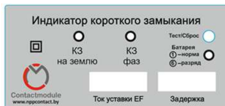
Рисунок 1.1 Передняя панель ИКЗ
