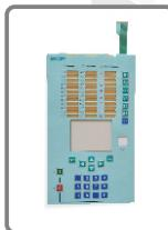
Клавиатуры выполнены на гибких печатных платах на основе полиэфирных пленок толщиной 0,125-0,150 мм. **Проводники на гибких подложках формируются двумя основными способами:**
