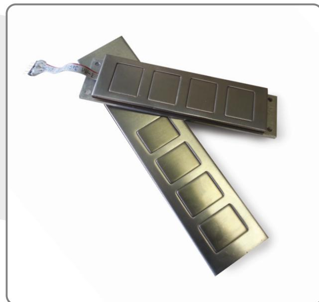
**огнем.** Клавиши имеют ограничитель хода (защита от «задавливания» коммутирующих мембран). Форма клавиш и символов - по желанию заказчика. Нанесение символов – лазерной либо фрезерной гравировкой с заливкой цветными эмалями. Коммутирующие мембранны установлены полностью герметично. Фронтальная поверхность клавиатуры - под заказ: глянцевая или текстурированная.
