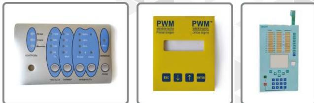
Клавиатуры выполнены на гибких печатных платах на основе полиэфирных пленок толщиной 0,125-0,150 мм. Проводники на гибких подложках формируются двумя основными способами:
