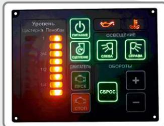
Технология **интеллектуальной подсветки** позволяет визуально (по цветам свечения) выделять функциональные зоны клавиатуры в зависимости от их назначения, либо отображать разными цветами включенную функцию каждой клавиши (если клавиша имеет несколько назначений). При нажатии на подсвеченную клавишу возможно кратковременное изменение цвета свечения клавиши для визуального восприятия срабатывания клавиши, а также цветовая (отличная от базового цвета) фиксация нажатой клавиши.
