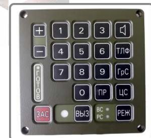
**нагреву открытым огнем.** Клавиши имеют ограничитель хода (защита от «задавливания» коммутирующих мембран). Форма клавиш и символов - по желанию заказчика. Нанесение символов – лазерной либо фрезерной гравировкой с заливкой цветными эмалями. Коммутирующие мембранны установлены полностью герметично. Фронтальная поверхность клавиатуры - под заказ: глянцевая или текстурированная.
