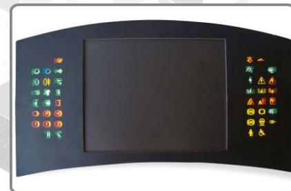
аварийных и иных сообщений на встроенных дисплеях, а также на дублирующих многоцветных световых табло (в том числе со скрытыми сигнальными мнемосимволами), обеспечивают звуковое/речевое дублирование предупредительных и аварийных сообщений.
