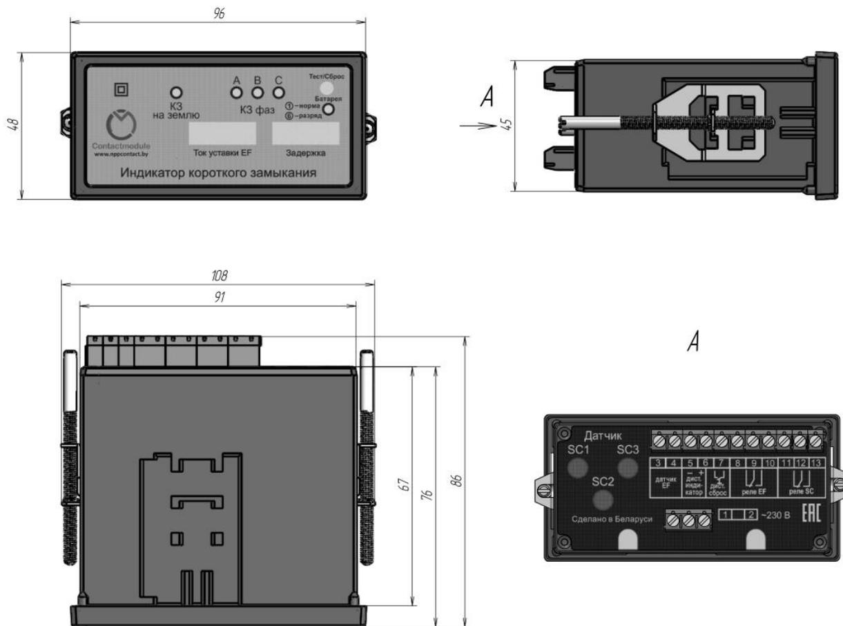
Рисунок А.1 – Габаритные и установочные размеры ИКЗ
