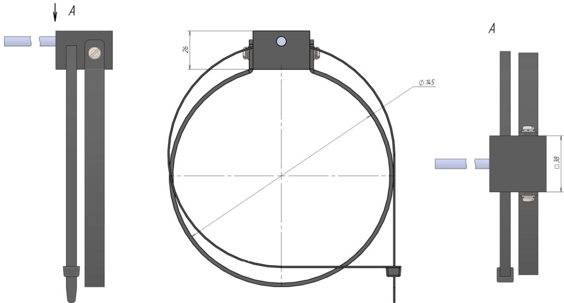
Рисунок А.2 – Габаритные и установочные размеры датчика EF
