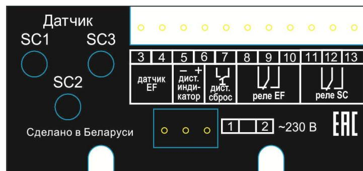
Рисунок 1.2 Задняя панель ИКЗ
