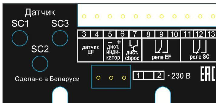
Рисунок 1.2 Задняя панель ИКЗ
