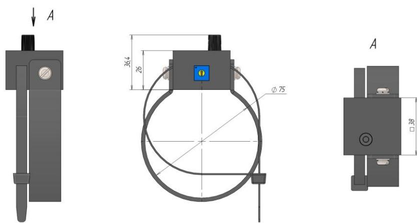
Рисунок А.3 – Габаритные и установочные размеры датчика SC
