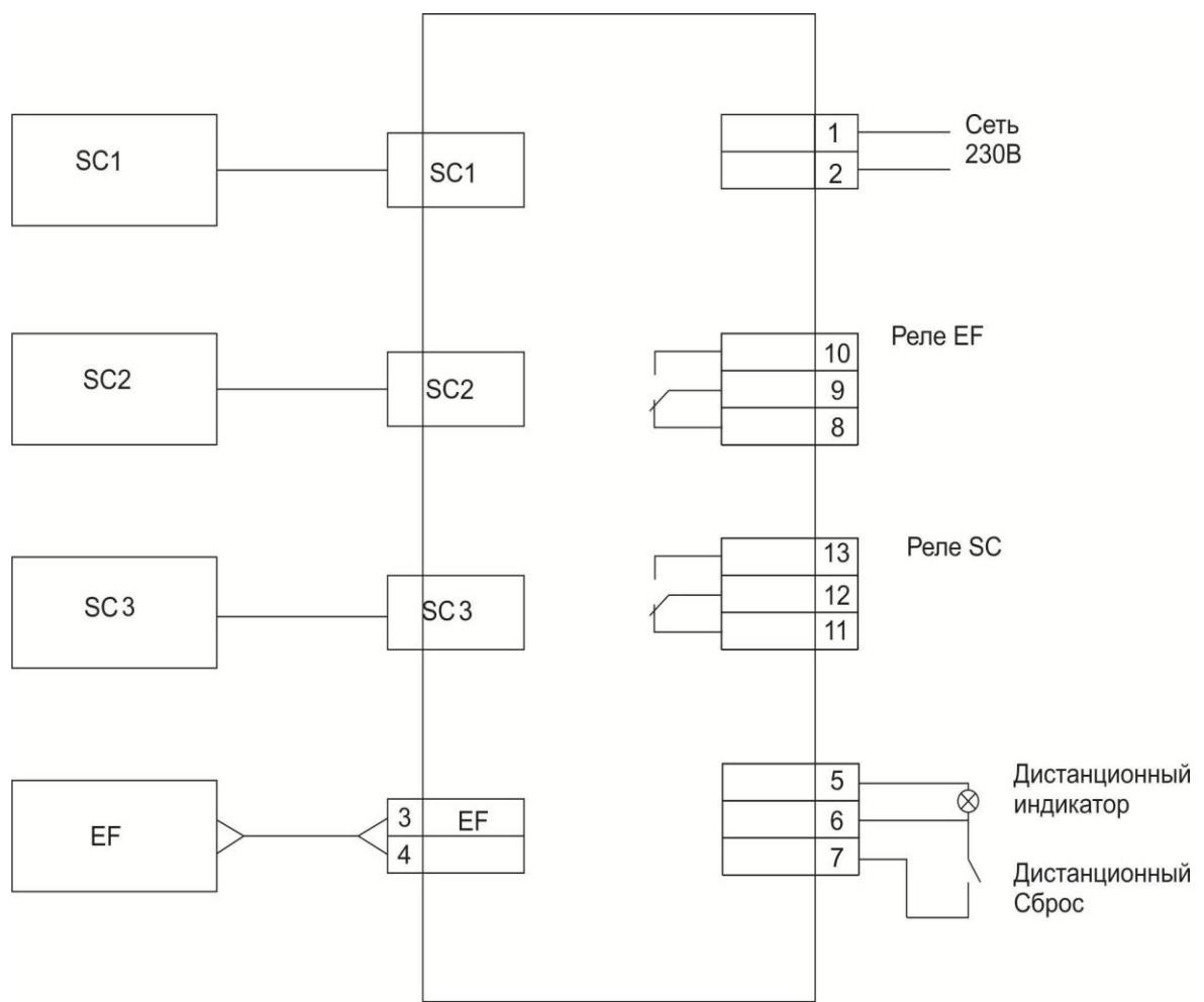
Схема подключения ИКЗ
