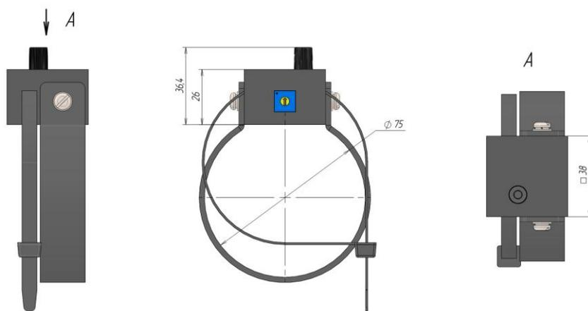
Рисунок А.3 – Габаритные и установочные размеры датчика SC
