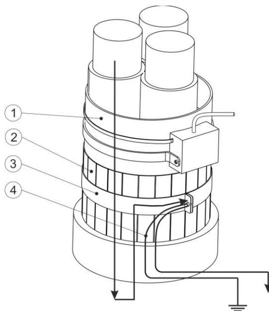
Рисунок 2.2 Датчик монтируется на экранированной части кабеля
