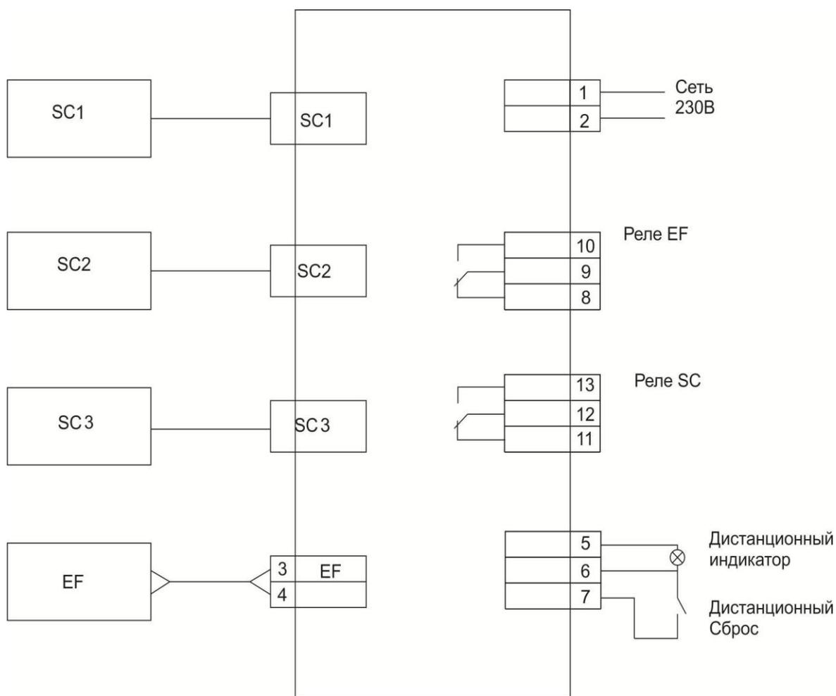
Схема подключения ИКЗ
