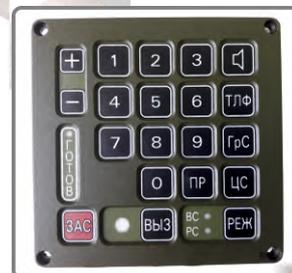
**нагреву открытым огнем.** Клавиши имеют ограничитель хода (защита от «задавливания» коммутирующих мембран). Форма клавиш и символов - по желанию заказчика. Нанесение символов – лазерной либо фрезерной гравировкой с заливкой цветными эмалями. Коммутирующие мембраны установлены полностью герметично. Фронтальная поверхность клавиатуры - под заказ: глянцевая или текстурированная.
