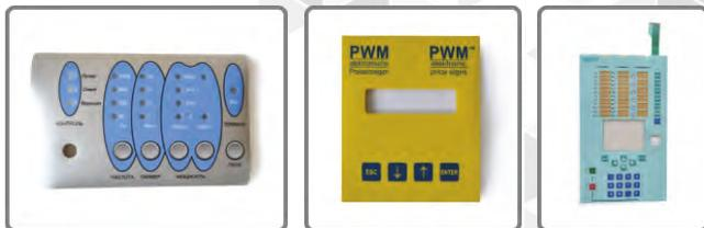
Клавиатуры выполнены на гибких печатных платах на основе полиэфирных пленок толщиной 0,125-0,150 мм.
